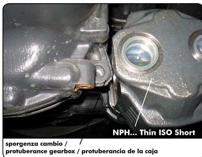
10) Collegare gli utilizzi ed il serbatoio e ripristinare il livello dell'olio nel cambio verificando l'assenza di perdite. Ripetere l'operazione di controllo perdite anche a distanza di alcune ore.
